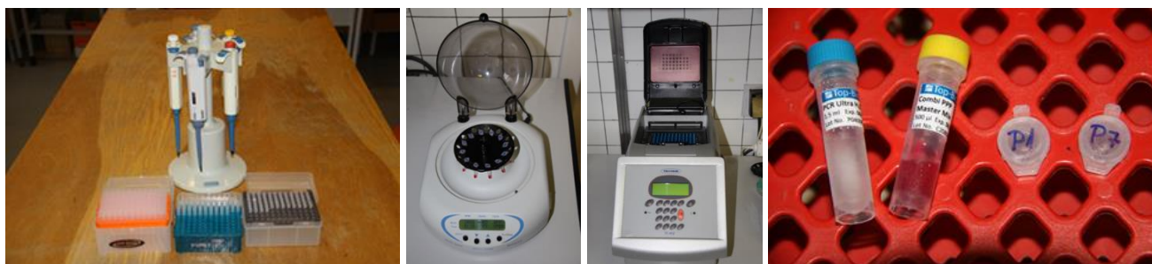
1. Pipety se špičkám. 2. Centrifuga s vortexem. 3. Termocyklér. 4. PCR voda, Combi PPP Master Mix, pracovní roztoky primerů,
