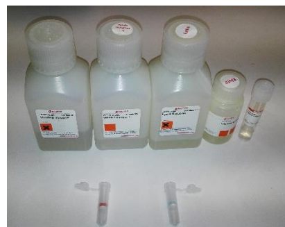
Na obrázku je vyobrazen tzv. kit pro izolaci RNA, soubor reagentů a 2 kolon. Modrá kolona slouží k filtraci roztoku, červená kolona obsahuje křemíkovou membránu, na kterou je RNA navázána a následně vymyta.
