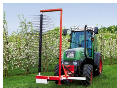
Stroj na mechanickou probírku květů Darwin (foto: Fruit Tec Maschinenbau)
