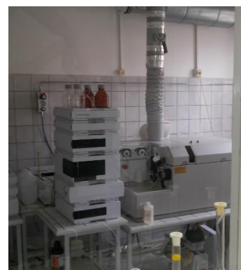
Hmotnostní spektrometr s indukčně vázaným plazmatem (přístroj vedle kapalinového chromatografu, napojený na odtah pomocí vzduchotechniky, laboratoř UKZÚZ
